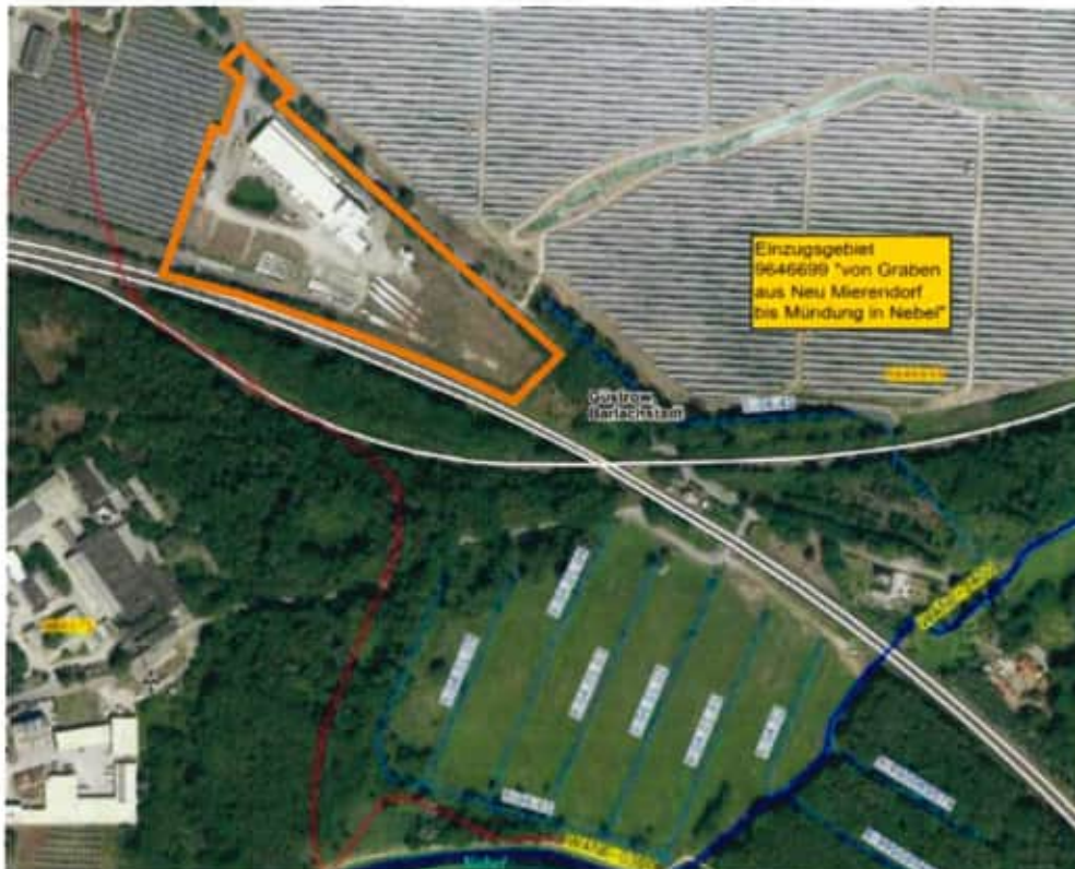
Abbildung 3: Darstellung des Einzugsgebietes „9646699“ (Grenzen in Rot dargestellt) des Oberflächenwassers im Plangebiet (Orange dargestellt) der Flussgebietseinheit „Warnow-Peene“ (Geoportal M-V); Luftbild © Geo Basis DE/M-V 2022
